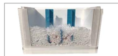
ドライアイスが昇華する際、上部のドライアイスが荷物を囲むように移動する構造により、荷室内の温度を維持します。
